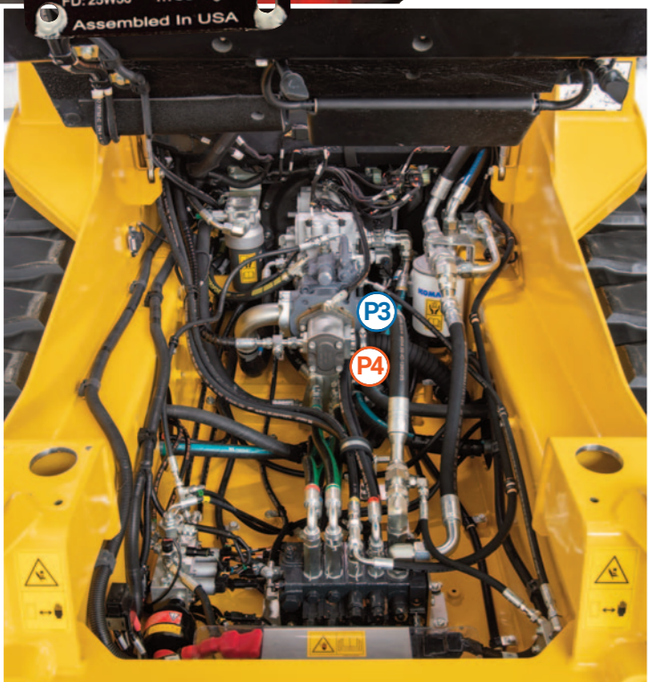
Distributore principale con spole controllate elettronicamente
