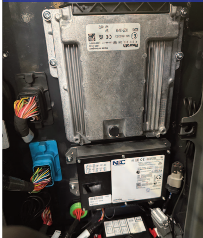
Sistema Komtrax di nuova generazione - connessione 4G
